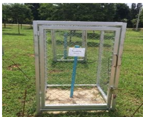
รูปที่ 3.7-11 หลุมตรวจวัดการเคลื่อนตัวของมวลดินในแนวราบบริเวณพื้นที่ก่อสร้างอุโมงค์แนวลาดและอุโมงค์แนวตั้ง
