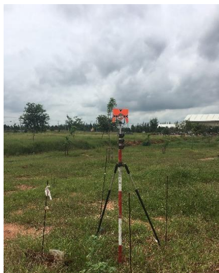
รูปที่ 3.7-2 การก่อสร้างหมุดหลักฐานอ้างอิง (Benchmark Point) และหมุดตรวจสอบบริเวณแนว การก่อสร้างขุดเจาะอุโมงค์แนวลาด
